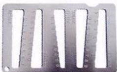
Ayuda a identificar los tamaños de pines en cilindros Kwikset, Schlage, Weiser, Weslock, y Master Lock . En base a los cortes en la llave.
