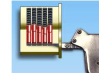
Tirando del gatillo se efectúan golpes individuales muy fuertes. Estos golpes se transmiten a los pines por la cuchilla y crean el "efecto de billar" para levantar los pines. Solo hay que agregar la tensión apropiada. El uso efectivo de esta herramienta requiere bastante práctica; pero es muy efectiva.
