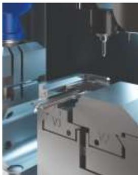
*La nueva generación de duplicadoras Multicode NXT permite el duplicado y grabado de llaves planas, de seguridad y automoción en una sola máquina.*
