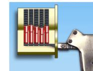
Tirando del gatillo se efectúan golpes individuales muy fuertes. Estos golpes se transmiten a los pines por la cuchilla y crean el "efecto de billar" para levantar los pines. Solo hay que agregar la tensión apropiada.
